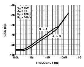
FIGURE 26. CHANNEL-TO-CHANNEL ISOLATION vs **FREQUENCY**
