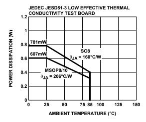
FIGURE 42. PACKAGE POWER DISSIPATION VS AMBIENT TEMPERATURE
