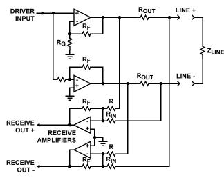
FIGURE 44. TYPICAL LINE INTERFACE CONNECTION
