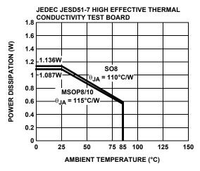
FIGURE 43. PACKAGE POWER DISSIPATION VS AMBIENT TEMPERATURE
