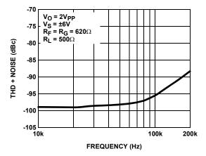
FIGURE 21. THD + NOISE vs FREQUENCY
