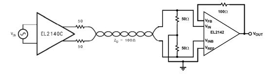
FIGURE 1. TYPICAL TWISTED PAIR APPLICATION
