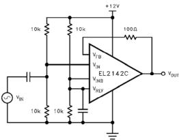
FIGURE 3. SINGLE SUPPLY RECEIVER
