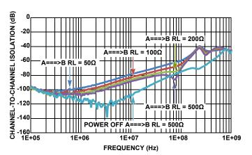
FIGURE 19. CHANNEL-TO-CHANNEL ISOLATION
