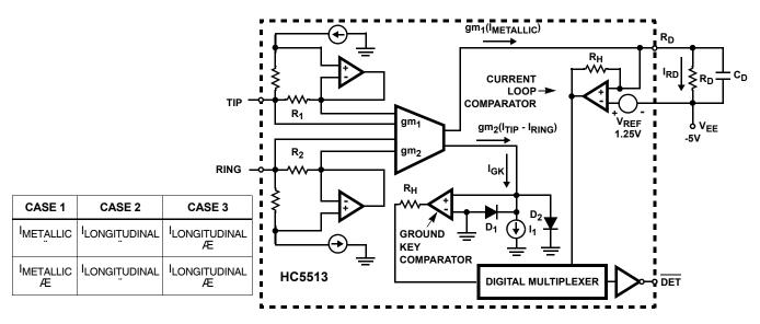
FIGURE 18. LOOP CURRENT AND GROUND KEY DETECTORS
