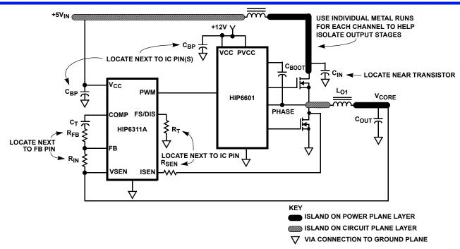
FIGURE 11. PRINTED CIRCUIT BOARD POWER PLANES AND ISLANDS
