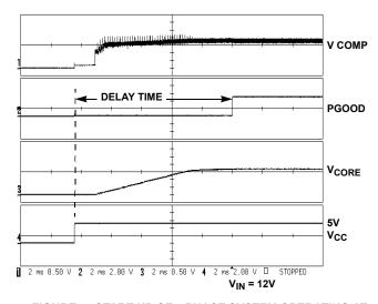
FIGURE 4. START-UP OF 4 PHASE SYSTEM OPERATING AT 200kHz
