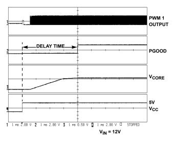
FIGURE 3. START-UP OF 4 PHASE SYSTEM OPERATING AT 500kHz
