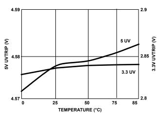
FIGURE 9. UV TRIP vs TEMPERATURE
