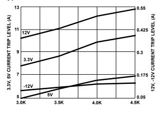
FIGURE 6. NOMINAL CURRENT TRIP LEVEL vs RCRSET
