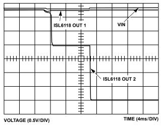
FIGURE 10. SWITCH FAULT INDEPENDENCE
