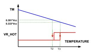
FIGURE 14. VR\_HOT SIGNAL vs TM VOLTAGE
