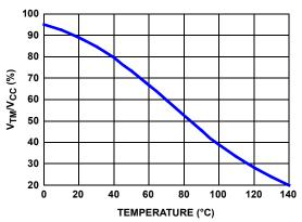
FIGURE 13. THE RATIO OF TM VOLTAGE TO NTC
