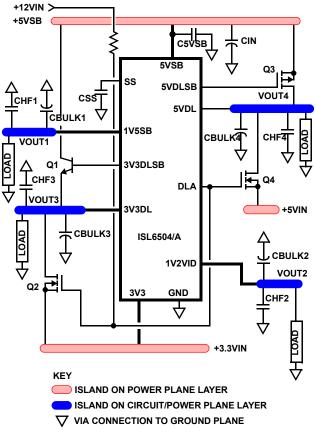
FIGURE 11. PRINTED CIRCUIT BOARD ISLANDS
