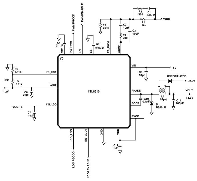
FIGURE 2. V<sub>IN</sub> RANGE FROM 5.5V TO 25V
