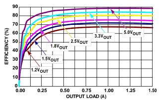
FIGURE 5. EFFICIENCY vs LOAD, V<sub>IN</sub> = 25V
