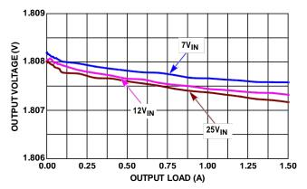
FIGURE 8. V<sub>OUT</sub> REGULATION vs LOAD, 500kHz 1.8V<sub>OUT</sub>
