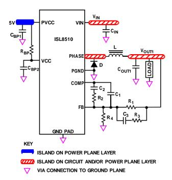
FIGURE 32. PRINTED CIRCUIT BOARD POWER PLANES
