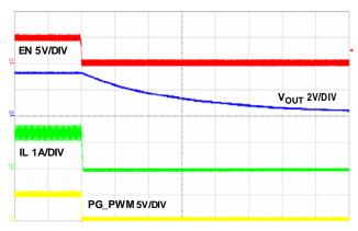
FIGURE 24. SHUT DOWN CIRCUIT, 100µs/DIV
