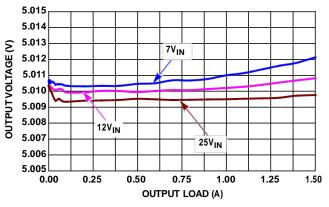
FIGURE 11. V<sub>OUT</sub> REGULATION vs LOAD, 5V<sub>OUT</sub>
