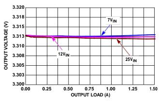
FIGURE 10.  $V_{\mbox{OUT}}$  REGULATION vs LOAD, 500kHz  $3.3V_{\mbox{OUT}}$
