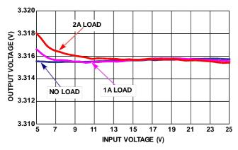
FIGURE 14. OUTPUT VOLTAGE REGULATION vs VIN
