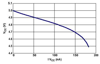
FIGURE 15. V<sub>CC</sub> LOAD REGULATION
