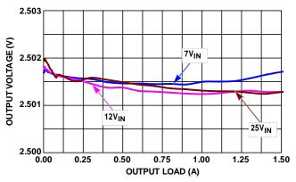
FIGURE 9. V<sub>OUT</sub> REGULATION vs LOAD, 500kHz 2.5V<sub>OUT</sub>
