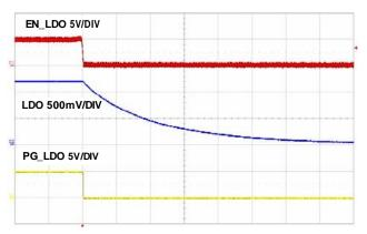
FIGURE 25. SHUT DOWN CIRCUIT, 20µs/DIV
