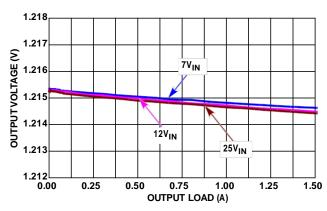
FIGURE 6.  $V_{\mbox{OUT}}$  REGULATION vs LOAD, 500kHz 1.2 $V_{\mbox{OUT}}$
