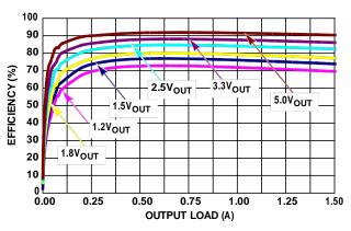
FIGURE 4. EFFICIENCY vs LOAD, V<sub>IN</sub> = 12V
