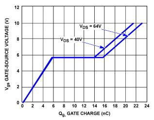
FIGURE 17. MOSFET GATE CHARGE vs GATE VOLTAGE
