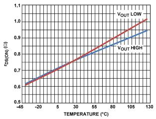
FIGURE 13. r<sub>DS(ON)</sub> vs TEMPERATURE
