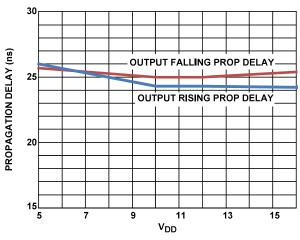
FIGURE 15. PROPAGATION DELAY vs V<sub>DD</sub>
