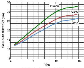
FIGURE 11. I<sub>DD</sub> vs V<sub>DD</sub> (1MHz)
