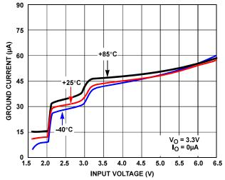
FIGURE 9. GROUND CURRENT vs INPUT VOLTAGE
