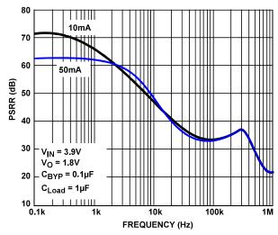
FIGURE 16. PSRR vs FREQUENCY
