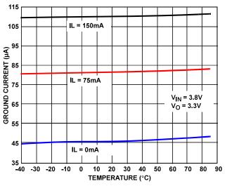
FIGURE 11. GROUND CURRENT vs TEMPERATURE
