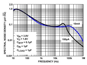
FIGURE 17. SPECTRAL NOISE DENSITY vs FREQUENCY
