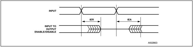
Figure 30. Asynchronous Reset / Preset
