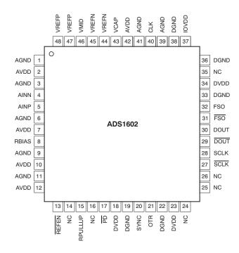
TQFP PACKAGE (TOP VIEW)
