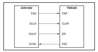
Figure 54. ADS1602—TMS320 Interface Connection
