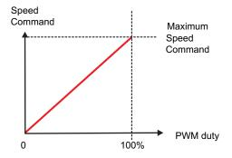
Figure 29. PWM-Mode Speed Command
