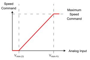
Figure 28. Analog-Mode Speed Command
