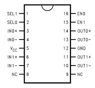
Figure 1. DS10CP152Q Pin Diagram
