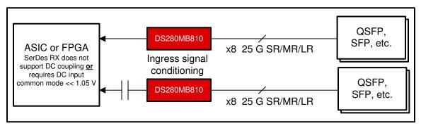
Figure 9-8. DS280MB810 or DS280DF810 recommended for front-port Ingress
