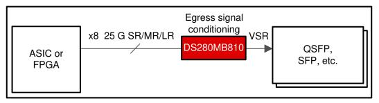
Figure 9-6. DS280MB810 recommended for front-port Egress
