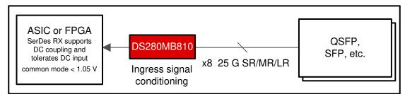
Figure 9-7. DS280MB810 recommended for front-port Ingress
