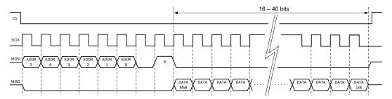
Figure 7-7. SPI Read Frame
