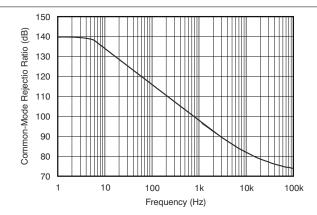
Figure 6-3. INA284-Q1 Common-Mode Rejection Ratio (RTI)
