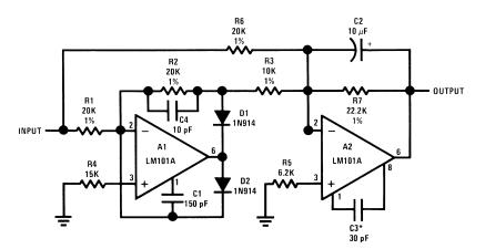
Figure 42. Fast AC/DC Converter<sup>(1)</sup>
