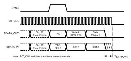
Figure 17. AC Link Powerdown Timing
