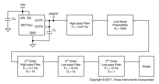
Figure 8-9. 1/f Noise Test Setup
