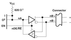
(d) SEPARATE ACTIVE-HIGH INPUT, OUTPUT, AND ENABLE
