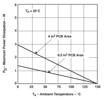
Figure 25. SOT223 Power Dissipation
