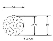
Figure 17. 7 Conductors
